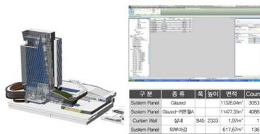
시공단계에서의 설계변경 및 자재변경 등으로 인한 변경 사항 BIM 모델 반영한 물량 산출 → 공사비 산출(물량x단가) → **정확한 공사비 관리**
